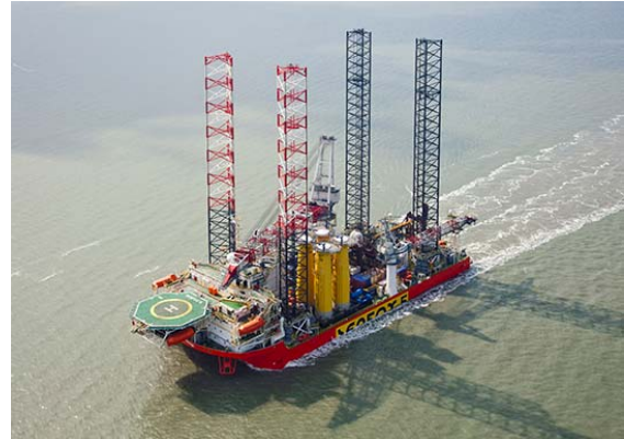
Figure 10 : Un exemple de navire pour le montage des éoliennes (Technip, 2013)
