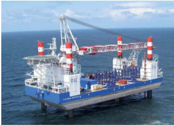
Figure 9 : Un exemple de plate-forme « Jack-up 5 » utilisée pour la mise en place des pieux (Technip, 2013)
