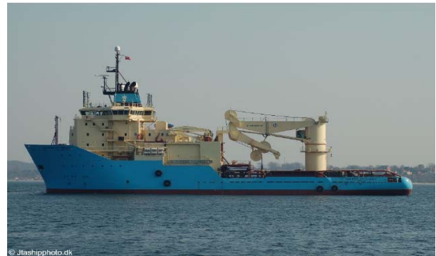
Figure 12 : Un exemple de navire câblé utilisé pour la mise en place des câbles inter-éoliennes et de la liaison sous-marine de raccordement (zone offshore) (Technip, 2013)
