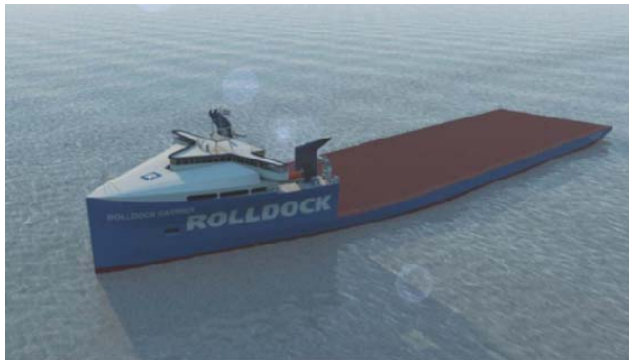
Figure 11 : Un exemple de barge DP2 utilisée pour le transport des fondations jacket (Technip, 2013)
